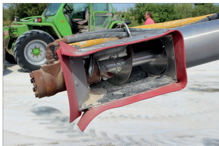
Ramena pro aplikaci práškových hnojiv mají šnekové dopravníky s pohonem od hydromotorů. Nové modely rozmetadel Bredal jsou osazeny hydromotory se zvýšeným výkonem
