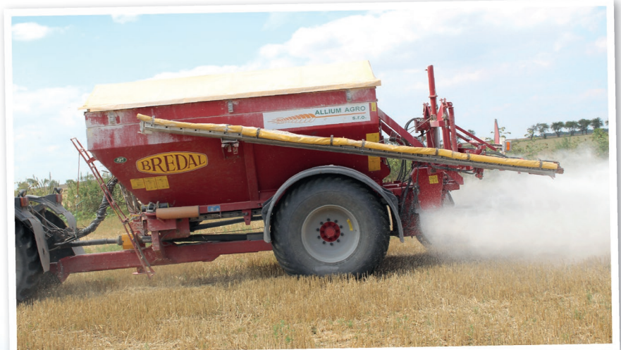
Aplikace hnojiv rozmetadlem Bredal K105L je velmi přesná a rovnoměrná. Zachování dávkování i při proměnlivé jezdové rychlosti zajišťuje elektrohydraulická regulace rychlosti pohybu dopravníku
