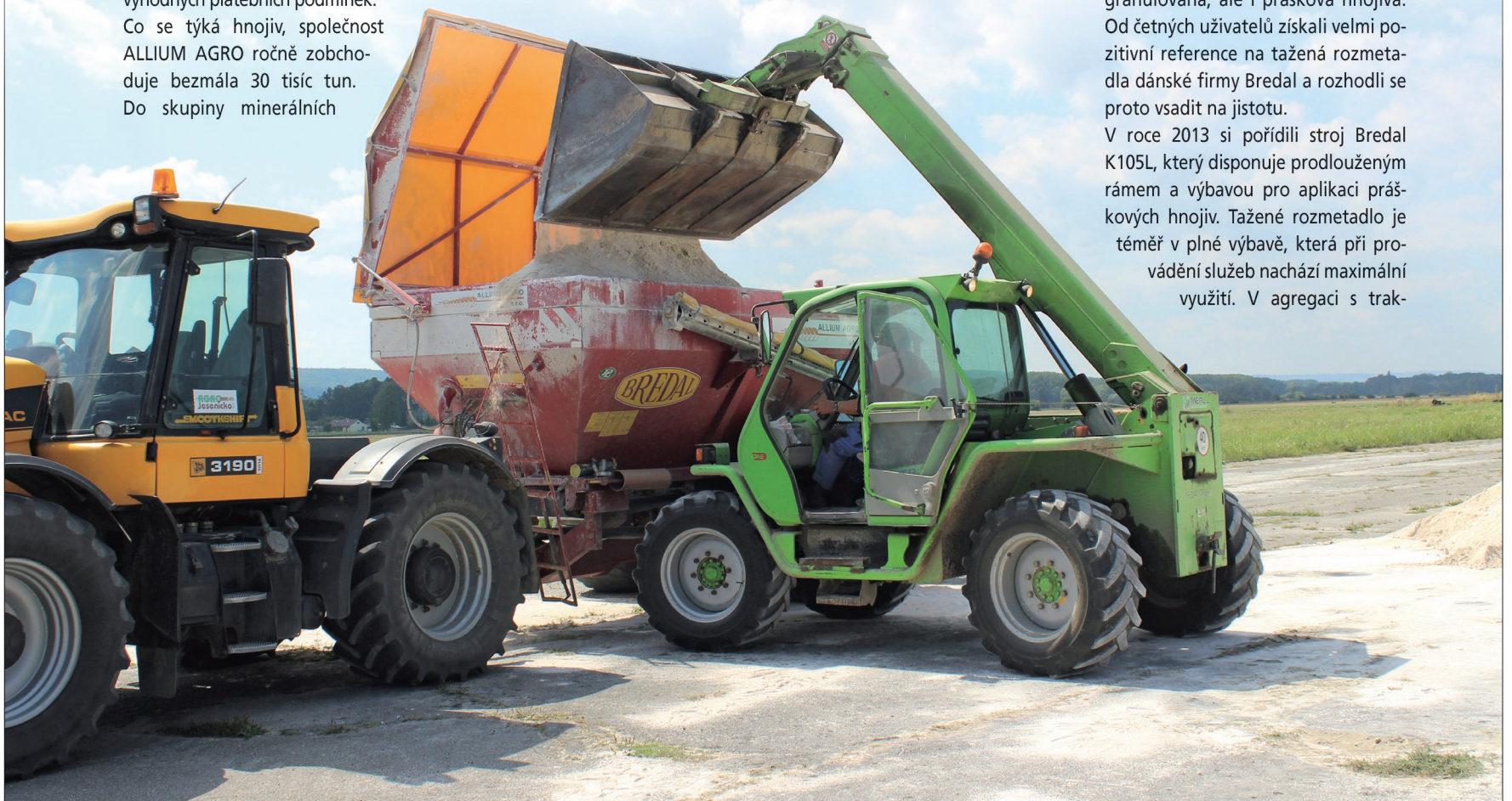
Zásobník rozmetadla má kapacitu 10 600 l a pojme 10 000 kg granulovaného hnojiva nebo 14 000 až 15 000 kg vápence. Hydraulicky ovládaný kryt je praktickou záležitostí
