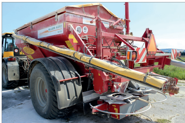
Prodloužený rám a ramena se záběrem 12 m s hydrostaticky poháněným šnekovým dopravníkem dovozuji aplikaci práškových hnojiv. Je to jedna z velkých předností rozmetadel značky Bredal, k další patří i jednoduchá přestavba na aplikaci granulovaných hnojiv
