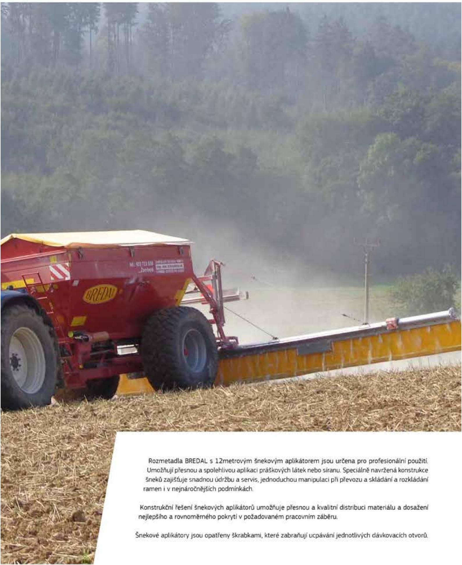
Rozmetadla BREDAL s 12metrovým šnekovým aplikátorem jsou určena pro profesionální použití. Umožňují přesnou a spolehlivou aplikaci práškových látek nebo síranu. Speciálně navržená konstrukce šneků zajišťuje snadnou údržbu a servis, jednoduchou manipulaci při převozu a skládání a rozkládání rámů i v nejnáročnějších podmírkách.
